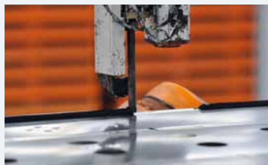
Terostat MS 接着剤が自動的に鉄骨フレームに押し出され、フレームと反射ミラーを接着します。
